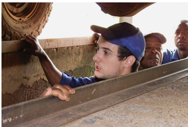
In der Werkstattgrube lassen sich die Fahrzeuge von unten prüfen.
